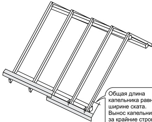
Общая длина капельника равна ширине ската. Вынос капельника за крайние стропила не более 300 мм
